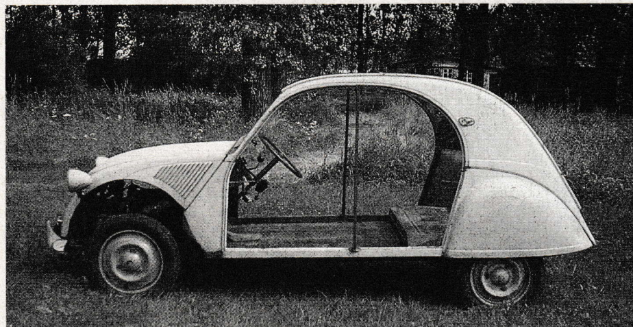
Ente, fast ausgenommen: Der Aufbau der französischen Auto-Legende macht dem Restaurierer seine Arbeit leicht.
