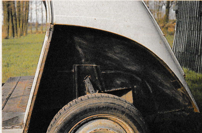
Alles noch solide: Kein Gramm Rost bröselte aus den Radhäusern.
