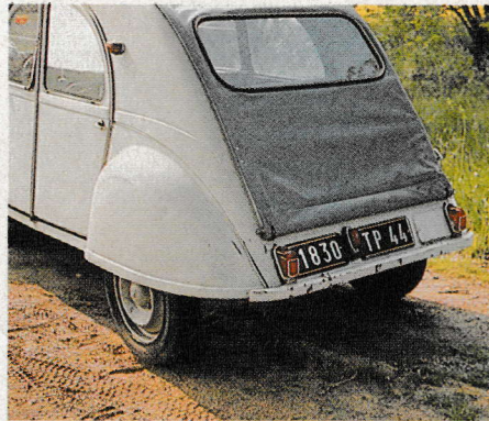
Viele kleine Rempfer mußte der 2 CV im Laufe seines Lebens einstecken. Neben den Beulen und Beulchen störte das selbstgebastelte Rolldach des letzten Besitzers das Auge des Puristen.
